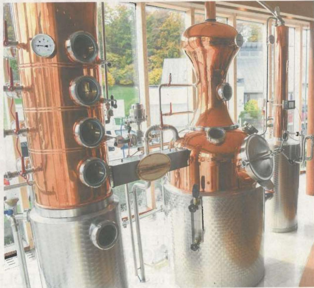
Die Feinbrandblase (Mitte) mit anschließender Kolonne (links) kann auch für Obstbrände verwendet werden und gibt den Whiskys den letzten Schliff
